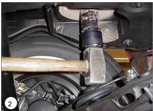
**NL** Plaats de MAD buffer in het gat van de originele buffer en laat de auto zakken met een voorwerp tussen de buffer en de draagarm. Laat de auto zover zakken tot dat de buffer in de houder klikt.
