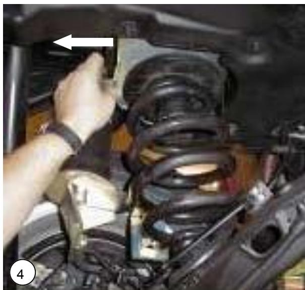
**NL** Druk de bovenbeugel zover mogelijk naar achteren (zie pijl) en monter de hoofdveer. Montere de onderste schokdemper bevestiging (**150 Nm+90°**) en het steuntje van de ABS kabel.
