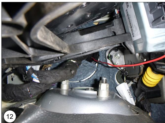
**NL** Verwijder de drie moeren van de bovenste bevestiging om de veerpoot te demonteren.
