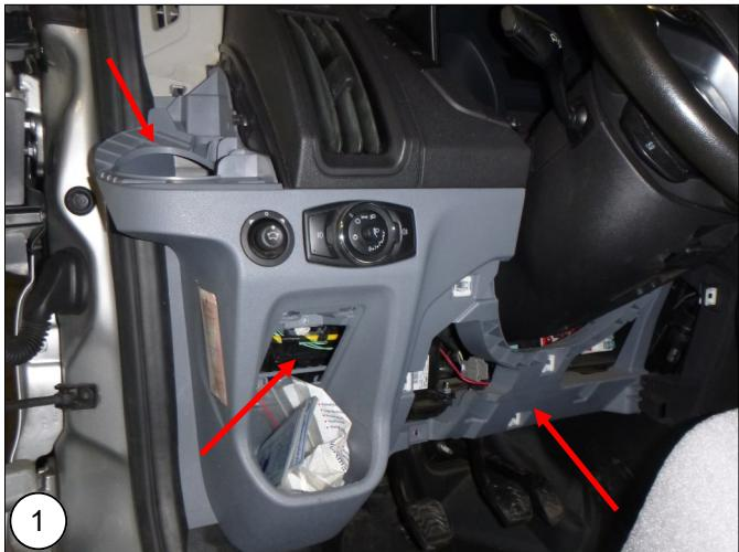
**NL** Om de bovenste bevestiging van de veerpoten te kunnen bereiken, moeten diverse interieurdelen worden verwijderd. **Bestuurderszijde:** Verwijder de drie aangegeven panelen.
