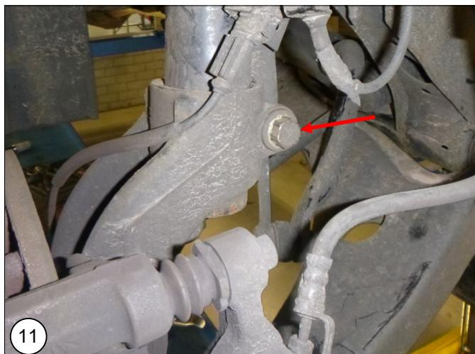
**NL** Demonteer de fuseebout. Gebruik een spreider en laat de fusée zakken totdat de veerpoot vrij is. Indien het fusée niet ver genoeg zakt, demonteer dan de fuseekogel of draagarmbouten.
