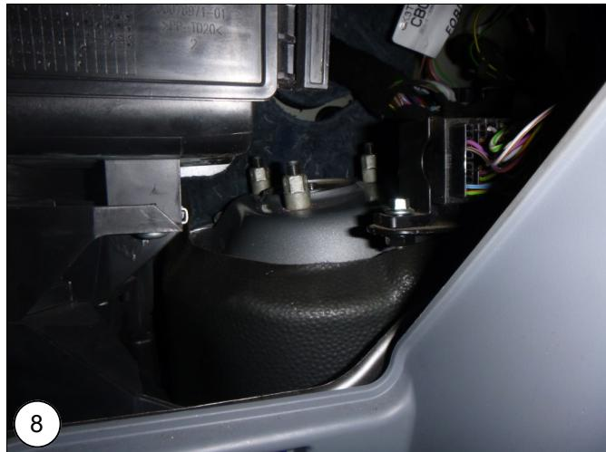
**NL** Verwijder de kap bovenop de bevestiging van de veerpoot. Draai de drie moeren los totdat ze met de hand los te draaien zijn.
