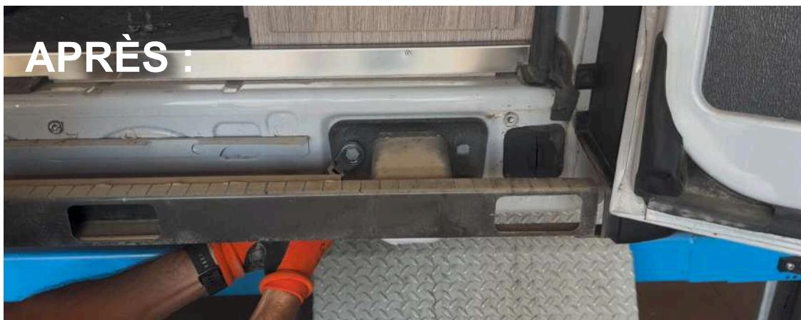
Déposer la traverse noir arrière et supprimez le boulon soudé des deux côtés :
