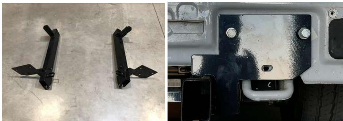
**Refixer la traverse d'origine sur les supports du porte-moto Edivan :** Sur certains modèles récents, il peut être nécessaire de **percer et d'agrandir le trou du boulon supérieur interne** s'il est fermé, en veillant à ne pas endommager le filetage existant.
