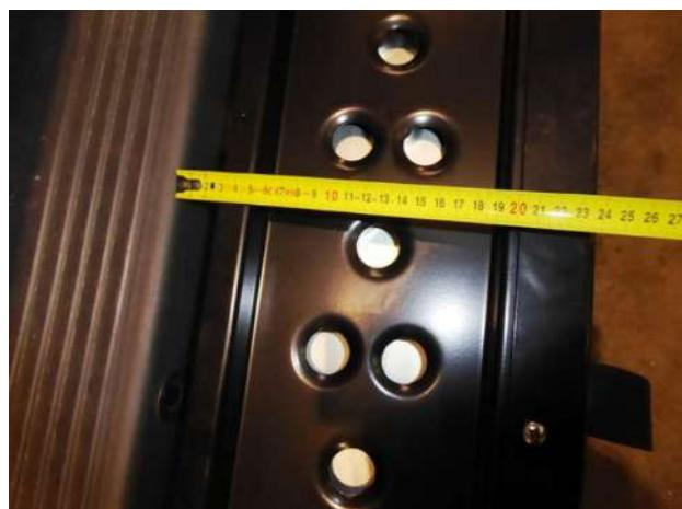
**Positionner la goupille d'arrêt pour bloquer la rampe à la dimension souhaitée.**
