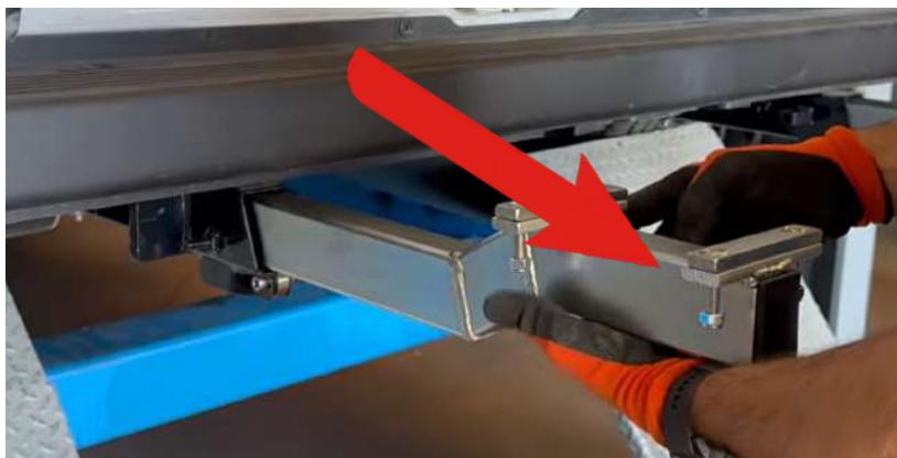
récupérer les pattes de fixation qui sont installées sur les supports afin de les insérer dans le porte-moto.
