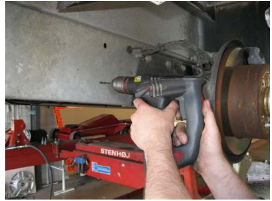
Photos N° 16 et 18 Renforcement à l'aide de la plaque spéciale à l'intérieur du châssis
