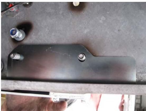
Photos N° 16 et 18 Renforcement à l'aide de la plaque spéciale à l'intérieur du châssis
