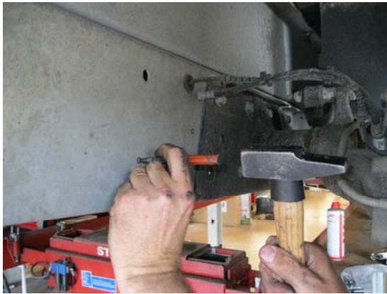
Photos N° 16 et 18 Renforcement à l'aide de la plaque spéciale à l'intérieur du châssis
