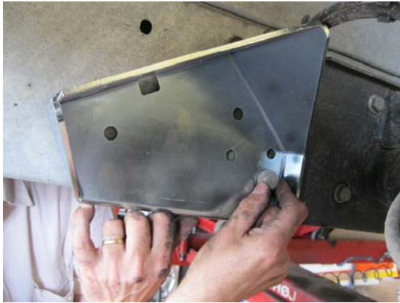
Photos N° 11 et 12 Perçage des trous manquants
