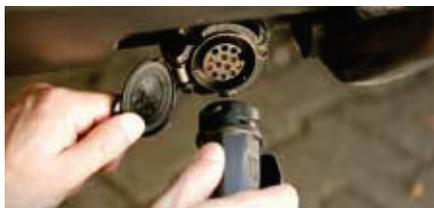
L'alimentation électrique du véhicule se fait avec une fiche 13 broches.
